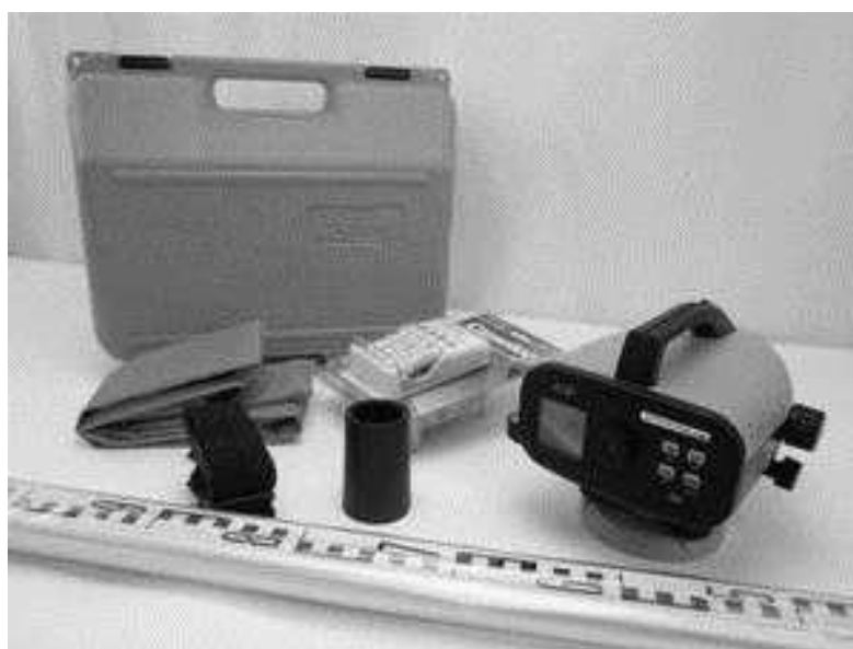
6-сурет – Leica Sprinter 100 нивелирінің және оның компоненттерінің суреті
