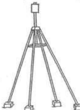
4-сурет – Элементтің сыртқы белгісі – үш қырлы металл пирамида
